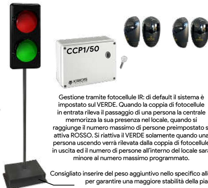
Gestione tramite fotocellule IR: di default il sistema è impostato sul VERDE. Quando la coppia di fotocellule in entrata rileva il passaggio di una persona la centrale memorizza la sua presenza nel locale, quando si raggiunge il numero massimo di persone preimpostato si attiva ROSSO. Si riattiva il VERDE solamente quando una persona uscendo verrà rilevata dalla coppia di fotocellule in uscita ed il numero di persone all'interno del locale sarà minore al numero massimo programmato.
